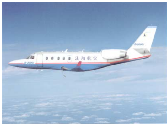
圖1: (左)AIDC ASTRA噴射飛機拋投dropsonde實景。(右)ASTRA機艙內的AVAPS和RD93。
