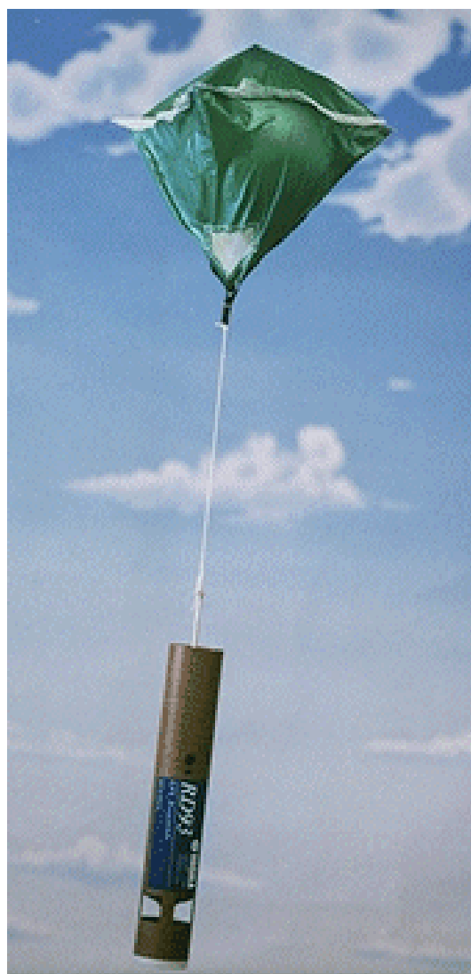
圖2: (左) Vaisala RD93實體大小(右) RD93空中降落示意圖。
